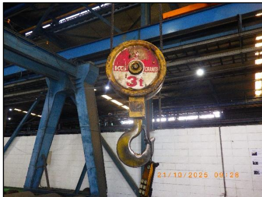
รูปที่ 2.35 ป้ายบอกพิกัดน้ำหนักรถไถที่ปั่นจั่นและรอกของตะขอ
