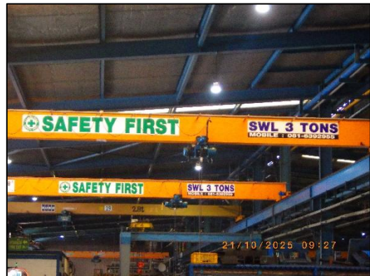
รูปที่ 2.35 ป้ายบอกพิกัดน้ำหนักรถไถที่ปั่นจั่นและรอกของตะขอ
